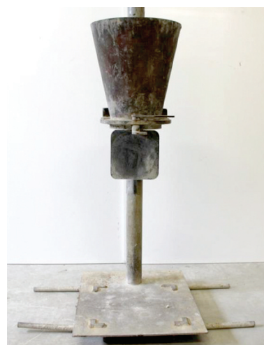
Figure 9 Cône de l'appareil de Glanville, trappe inférieure ouverte
