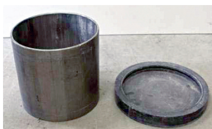
Figure 8 Moule métallique \varnothing 16 cm x 16 cm et son fond en PVC
