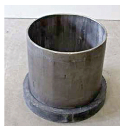
Figure 9 Cône de l'appareil de Glanville, trappe inférieure ouverte
